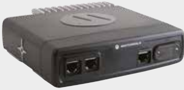
ETHERNET-ERWEITERUNGSKOPF 2X ETHERNET-STD, ETHERNET-SIM-LESEGERÄT UND RS232
