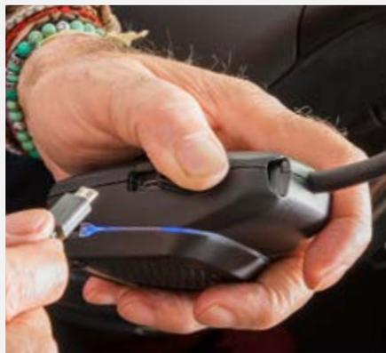
DUALMIKE può essere ricaricato tramite la presa USB sul microfono oppure dalla presa del CB collegata alla presa USB del cavo.
